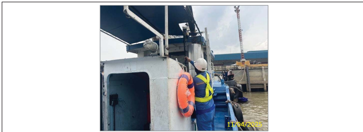
รูปที่ 3-8 การตรวจวัดระดับเสียงของเรือลากจูงที่เข้าเทียบท่า
